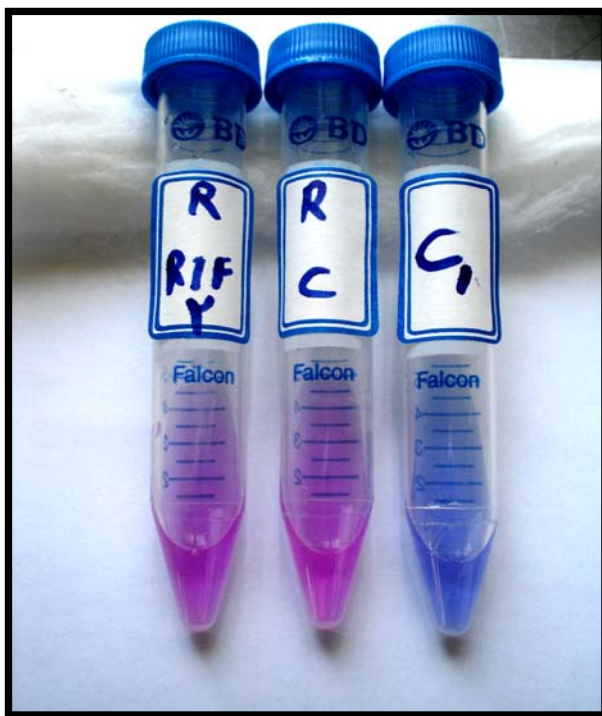
شکل ۲: تغییر رنگ آلاماربلو در محیط حاوی ریفامپین (سویه مقاوم) C: کنترل مثبت، C 1 : کنترل منفی
